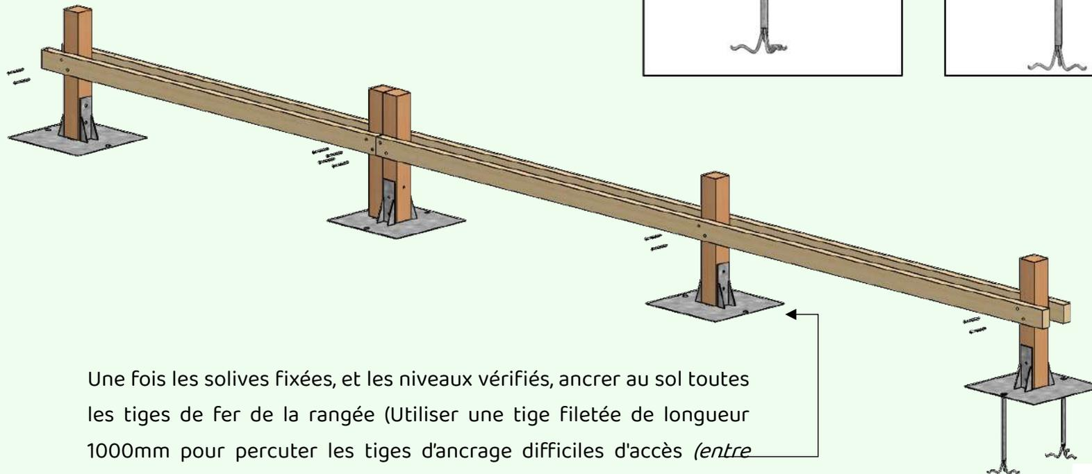
Une fois les solives fixées, et les niveaux vérifiés, ancrer au sol toutes les tiges de fer de la rangée (Utiliser une tige filetée de longueur 1000mm pour percuter les tiges d'ancrage difficiles d'accès (entre solives))
