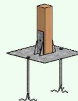
Ancrer au sol la première platine en enfonçant et percutant les tiges de fer.
