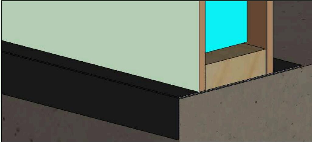
6 - Mise en place du pliage aluminium, maintenue en position par 2 cordons de mastic colle, sur le mur et sur la bande d'arase.
